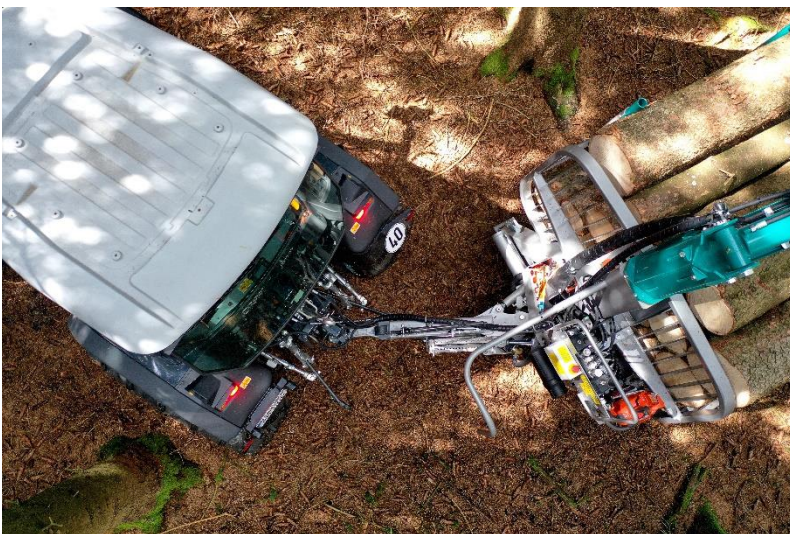
Abbildung 4 (220802_sline_s8_lenkdeichsel.jpg): Eine Lenkdeichsel mit zwei starken Zylindern ermöglicht ein problemloses Rangieren auch in engen Beständen.
