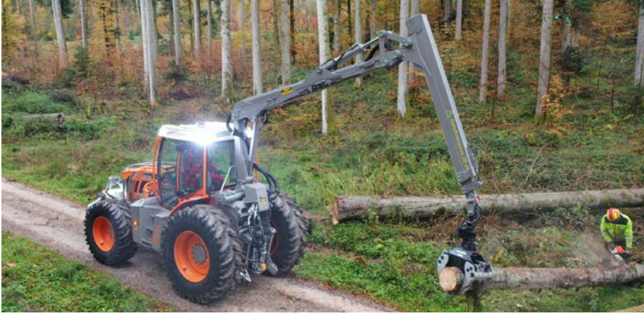
Der Pm Trac bei der Langholzernte. Der Kranfuß ist über der Hinterachse angebracht. Auf eine Seilwinde verzichtet der Forstunternehmer.
