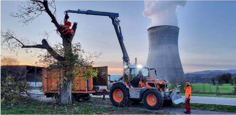
Baumfällung mit Pm Trac und Westtech Greifersäge CS510 direkt an einer vielbefahrenen Straße.
