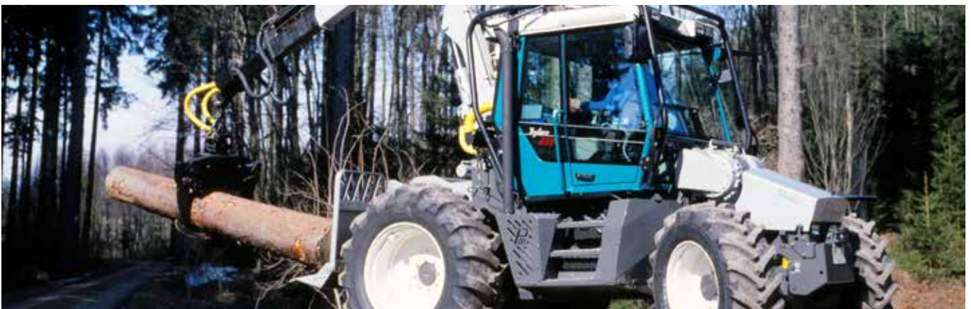
Un des premiers tracteurs Xylon transformé par la société Pfanzelt pour l'utilisation forestière.
